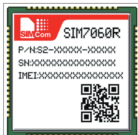
Рис. Модуль SIM7060R с поддержкой B31 (450 МГц)
