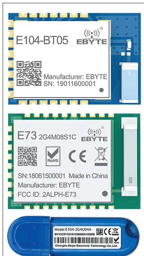
Рис. 9. Типовые варианты исполнения модулей Bluetooth компании EBYTE
