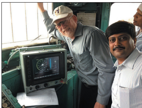
Рис. 2. Внешний вид терминала машиниста системы управления поездами индийских железных дорог на этапе внедрения
