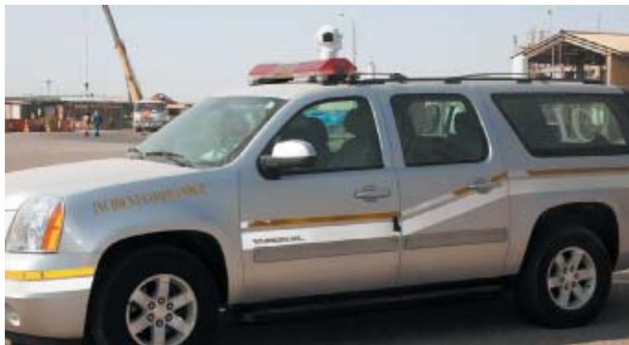
Рис. 3. Аварийно-спасательный автомобиль с установленной на крыше удаленно управляемой камерой
