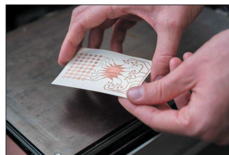
Рис. 1. Конструкция антенны напечатана на гибкой, покрытой медью жидкокристаллической полимерной подложке с использованием метода маскирования с помощью струйной печати с последующим травлением
