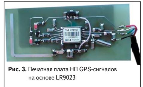
Рис. 3. Печатная плата НП GPS-сигналов на основе LR9023
