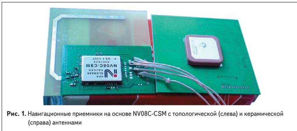
**Рис. 1.** Навигационные приемники на основе NV08C-CSM с топологической (слева) и керамической (справа) антеннами
