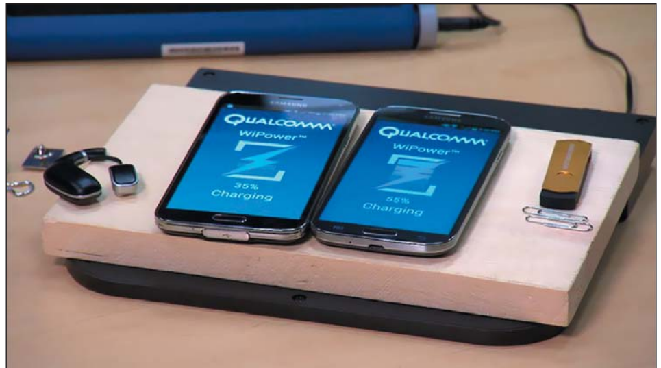
Рис. 2. ЗУ на основе технологии магнитного резонанса позволяют осуществлять зарядку на расстоянии, через различные материалы — от дерева и гранита до кожи (включая ткани тела) и воды, а также способны заряжать более одного устройства за один раз
