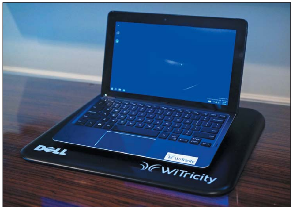
Рис. 10. Зарядный коврик использует магнитный резонанс для заряда батарей. Dell сделала ставку на разработку компании WiTricity, наряду с Intel входящей в альянс Alliance For Wireless Power (A4WP)
