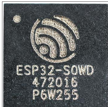
Рис. 1. Пример маркировки на корпусе чипа серии ESP32
