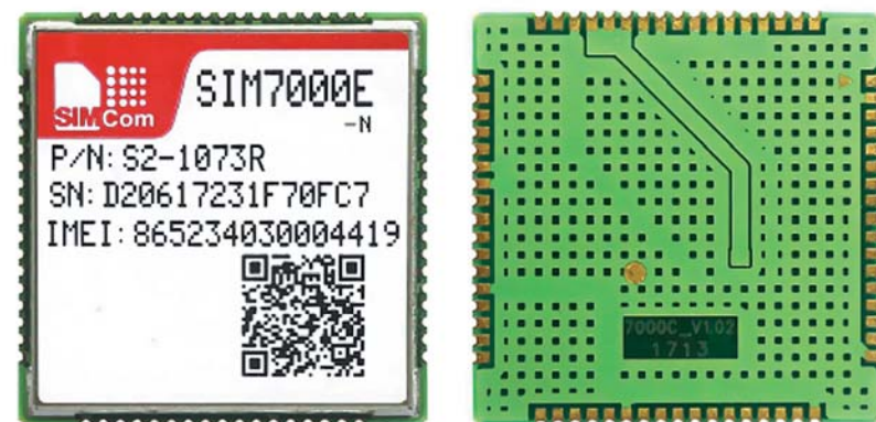
Рис. 3. Мультидиапазонный NB-IoT/GSM-модуль SIM7000E-N (слева — вид сверху, справа — вид снизу)
