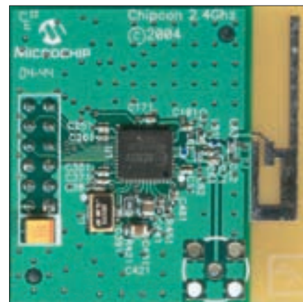
Рис. 1. Примеры монтажа трансивера CC2420 на переходную плату для отладочных целей
